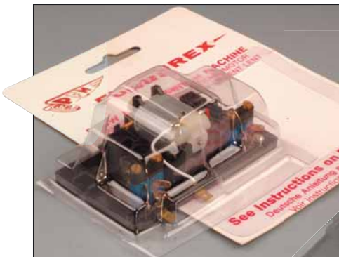
4 De overbekende wisselaandrijving van Fulgurex. Vroeger werd dezelfde wisselaandrijving ook onder de merknaam Lemaco en later Brawa verkocht. Deze aandrijving is standaard eendafgeschakeld en heeft twee extra hulpcontacten die nog met een paar uitgebreid kunnen worden.
