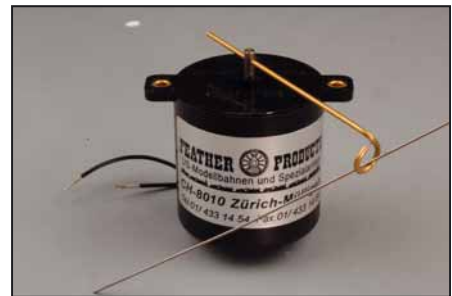
3 Een kwalitatief hoogstaande wisselmotor uit de Verenigde Staten vertegenwoordigd door de Zwitserse firma Feather. De aandrijving gebeurt door een precisie motor en een tandwielkast die met een frictiekoppeling met elkaar verbonden zijn. Door de frictiekoppeling kan de motor nooit verbranden doordat deze een groter koppel heeft dan het vast ingestelde koppel van de frictiekoppeling en daardoor in de koppeling blijft ronddraaien. De motor kan met behulp van externe hulpcontacten wel eendafgeschakeld worden. Iets dat overigens ook aan te bevelen is.
