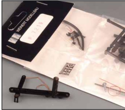
19 De universele wissellantaarn en aandrijfmechaniek van Weinert. Via een hefboom, die in de vork links in beeld gemonteerd moet worden, wordt de lantaarn synchroon met de wisseltong omgezet.
