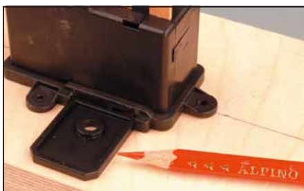
16 Eens nadat de wisselaandrijving uitgelijnd is ten opzichte van de hartlijn van de wissel, kan het boorgat met een standaard meegeleverde sjabloon eenvoudig op de onderzijde van de grondplaat gemarkeerd worden.
